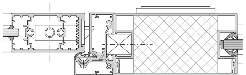
Türelement Alurahmentür 40 mm mit Schalterpaneel
